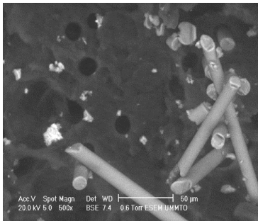
Fig. 8. Micrographie des faciès de rupture du mélange 90%PP/10%FV
