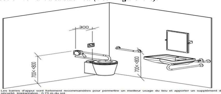
Les barres d'appui sont fortement recommandées pour permettre un meilleur usage du lieu et apporter un supplément de sécurité. Implantation : 0,75 m du sol.
