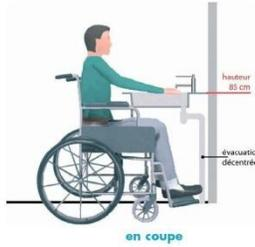
m entre les appareils ménagers installés ou prévisibles, les meubles fixes et les parois, et ce, hors du débattement de la porte. La hauteur des plans de travail se situe à 70 cm du sol (dessous
