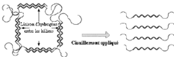
Figure 2 : Schéma représentatif de l'effet du cisaillement sur la structure de la solution de xanthane [12].
