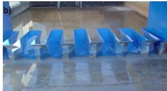
Figure 06: Model de PK-Weir : a) type A1m, b) type A
